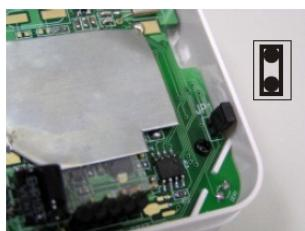
Датчик температуры помещения включен (заложен якорек)
