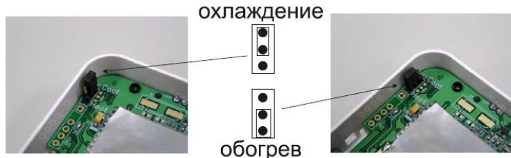
Выберите режим работы и переложите якорек, согласно вышеуказанному рисунку. Если выберете режим охлаждения, регулятор будет работать как охлаждающий комнатный термостат. При выборе режима обогрева регулятор будет работать с системой отопления или половым отоплением.
