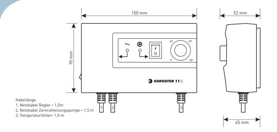
Das Schema ist vereinfacht dargestellt und enthält nicht alle Elemente, die für eine korrekte Installation notwendig sind. Fühler dürfen nicht in Flüssigkeiten getaucht und in Rauchgasabzügen montiert werden.
